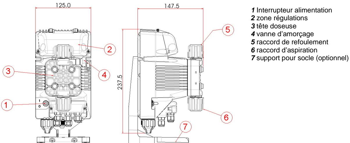
Les parties en contact avec le liquide ont été choisies pour garantir une compatibilité parfaite avec la plupart des produits chimiques normalement utilisés. Compte tenu de la variété de produits chimiques existant sur le marché, il est conseillé de vérifier la compatibilité chimique entre le produit dosé et les matériaux en contact.
