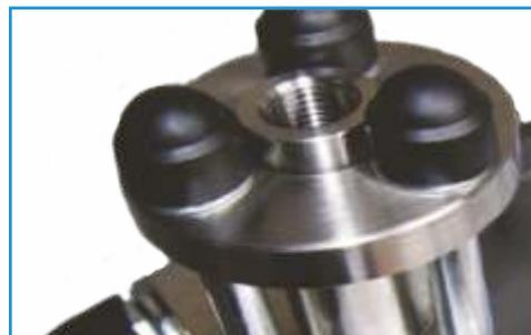
Al fine di assicurare la massima precisione nel dosaggio, anche per piccoli flussi, sono disponibili configurazioni a 2 o 3 sfere con alloggiamenti di alta precisione. Le guarnizioni metalliche per le teste in acciaio inossidabile AISI 316L e quelle in FPM per quelle in plastica, garantiscono la massima compatibilità
