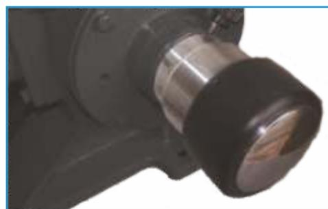
Una manopola facile da maneggiare e con un indicatore ad alta visibilità per la migliore regolazione del dosaggio
