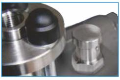
Oltre a garantire la ventilazione automatica durante il funzionamento, il sistema di ventilazione facilita l' innesco della pompa favorendo lo spurgo dell'aria mediante un'azione manuale
